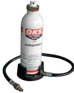
Und so geht's: Produkt in Airspray-Dose einfüllen, Steigrohr mit Adapter einführen, Ventil mit Sprühkopf auf Adapter aufsetzen und mit Überwurfmutter handfest verschrauben. Dose mit dem Ventil auf die Füllstation setzen, ca. 2 s nach unten drücken. Fertig zum Sprühen.
