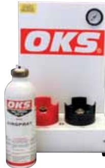
Und so geht's: Der Füllautomat wird über eine Ansaugleitung mit dem Produktbehälter verbunden. Dann wird die Airspray-Dose zum Befüllen in die „Wirkstoff-Luft-Entnahmestelle“ (rot) gedrückt. Über die zusätzliche „Luft-Entnahmestelle“ (schwarz) kann die Dose mit Druckluft be- bzw. nachgefüllt werden.
