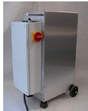
Zur Inbetriebnahme genügt der Anschluss die Wasserversorgung (mind. 3bar Druck) über eine Geka-Schnellkupplung und Kraftstrom 380V.
