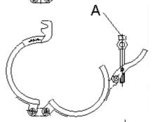
Schnellverschlussspannring um die Bördelkanten der zusammenzufügenden Rohrteile legen, chromatierten Zuganker einlegen und Spannringverbindung durch Umlegen des Spannhebels spannen. Auf korrekte Vorspannung achten! Vorspannung eventuell durch Drehen von Schraube "A" (im entspannten Zustand) korrigieren.
