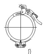
Spannhebel umlegen, um die Klemmung zu lösen.
